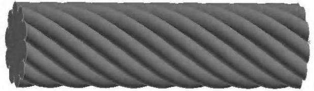
Рис. 1. Профилированная труба
