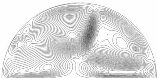
Рис. 5. Изолинии функции тока в трубе со скрученной лентой
