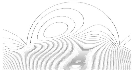
Рис. 2. Изолинии функции тока профилированной трубы
