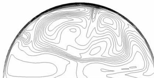
Рис. 6. Изолинии температуры в трубе со скрученной лентой
