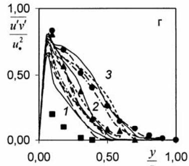
Рис.1. Радиальные распределения рейнольдсовских напряжений во входной области. Здесь линия - расчет [обозначения (—) - ПРН-L, (—) - М1, (- - -) - М2, (---) - М3-модели], значки – данные[10]: 1- $x/D=20$  (■), 2-30 (▲),
