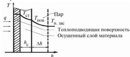
Рис. 2. Распределение температуры и фазовое сопротивление при сублимации
