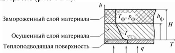
Рис. 1. Распределение температуры в материале в процессе сублимации при кондуктивном энергоподводе
